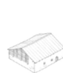
Toiture à deux pans
