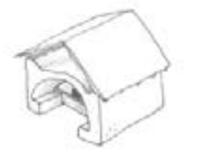
Base maçonnée des fours à pain. Voûte en pierre et mortier. Charpente simple à deux fermes, couverture en pierre plate ou ancelles. Absence de cheminée. Partie latérale pouvant servir de « remise » à bois. Volume simple, souvent situé le long d'une route ou sur une place publique
