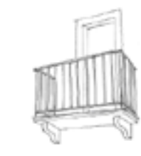
Balcons soutenus par des consoles et ferronnerie des garde-corps
