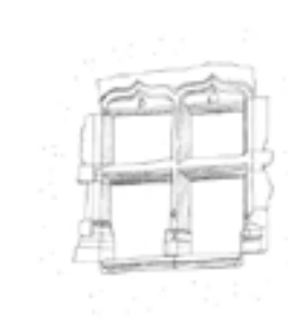
Baies anciennes (baie géminée, encadrement à meneau et traverse, arcs en accolade)
