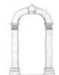
Encadrement de porte travaillé surmonté d'un arc en anse de panier flanqué de pilastres à chapiteaux
