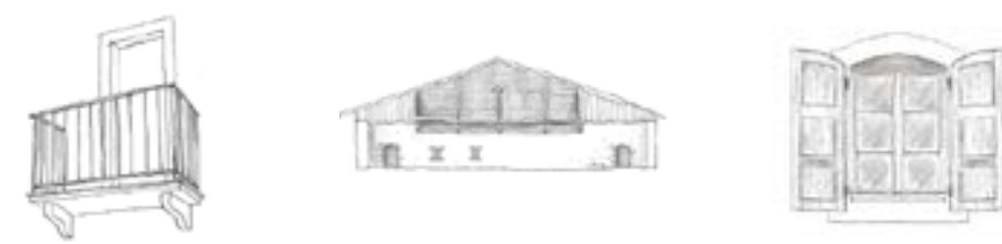
Garde-corps à barreaudages verticaux sur consoles
