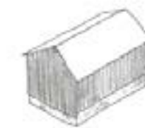
Peu de percements Bardage vertical en bois
